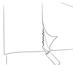
Scellement recouvrements de membrane à la colle
